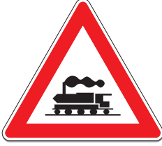
Kontrolsüz Demir Yolu Geçidi
